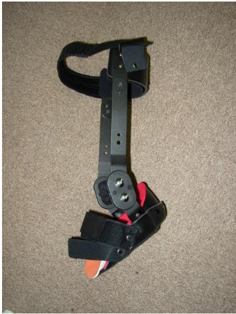
図 5. 内山式歩行装具：底屈制限はないが，ダイヤルロック式の背屈制限調節可能
